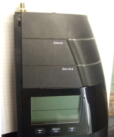
Bild 4: CCU mit SMA-Antennenbuchse
