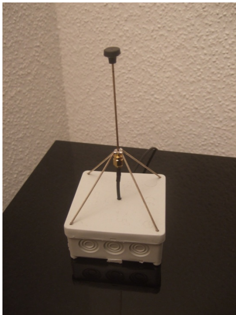
Bild 13: Die SMA-Platinenbuchse mit den angelöteten Radials und dem Strahler oben
