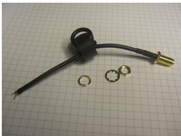
Bild 6: Der Antennenanschluss mit Ringkern
