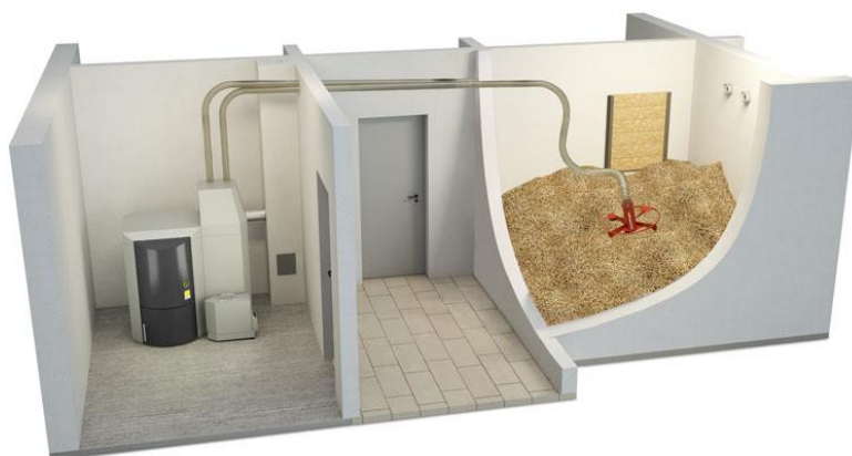
Maulwurf-Lagersystem schematisch
